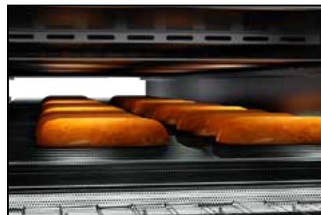
Perforerat stålbånd för bakning av fristående högre bröd med mycket volym så som limpor.
