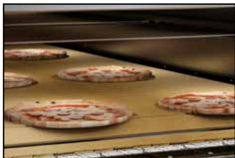
Stenhärdband för bakning av pizza, libabröd, pitabröd, naanbröd med mera.
