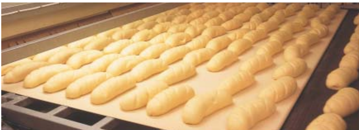
Jästa produkter i övergången mellan jäs- och ugnsbannorna.
